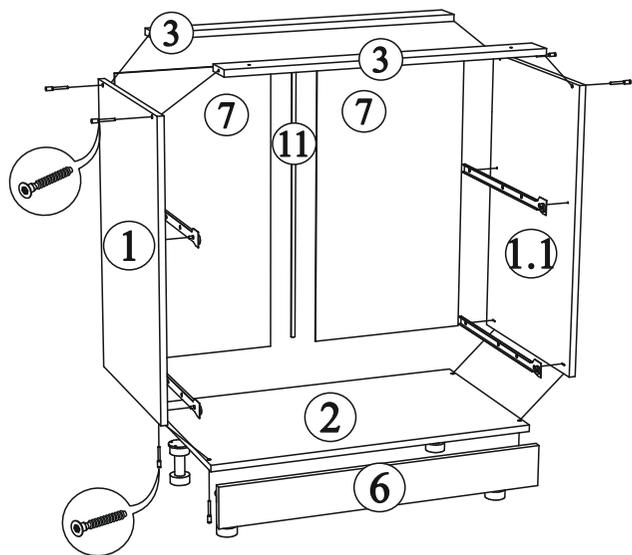
Опоры кухонные по наколам прикрутить с помощью шурупов 3,5x16 к крышке (деталь № 3).
