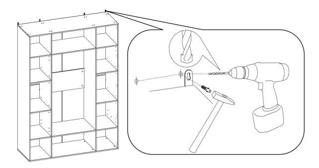
Для избежания повреждения газовых, вентиляционных водопроводных отверстий и электрических коммуникаций, обратите внимание на их расположение!
