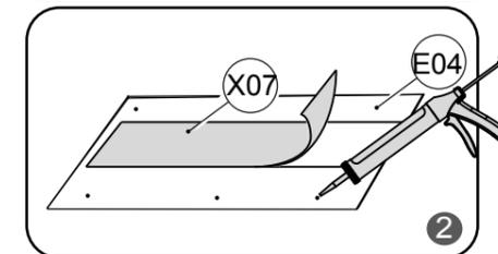
для более сильной фиксации рекомендуем использовать дополнительно клей-герметик типа жидкие гвозди. (Scotch-Seal 5300; Scotch-Wild 5300)
