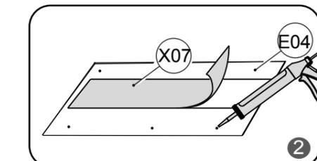
для более сильной фиксации рекомендуем использовать дополнительно клей-герметик типа жидкие гвозди. (Scotch-Seal 5300; Scotch-Wld 5300)
