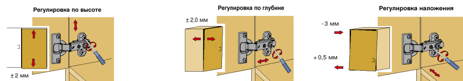
Рис.3 Схема установки петель
