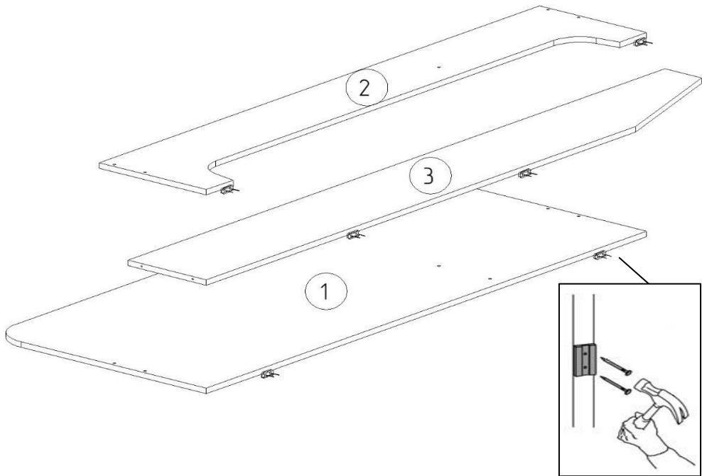
3. Установите на детали 1, 2, 3 подпятники с помощью гвоздей 2,0х25 мм.
