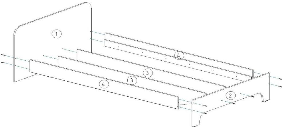
4. Соедините детали 3, 4 и детали 1, 2 с помощью винтов евро 7x50 мм.
