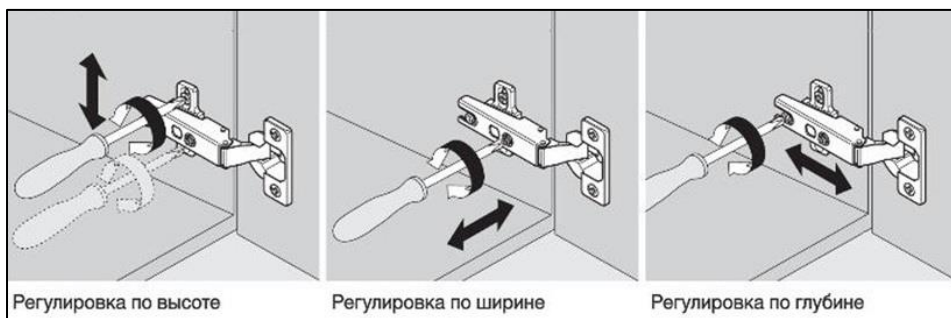
Рис. 1 Установка петель (установка на саморезы 4x16 мм)
