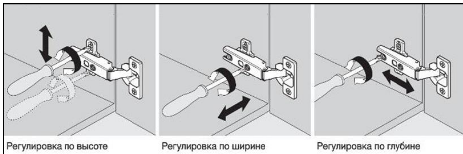
Рис. 1 Установка петель (установка на саморезы 4x16 мм)
