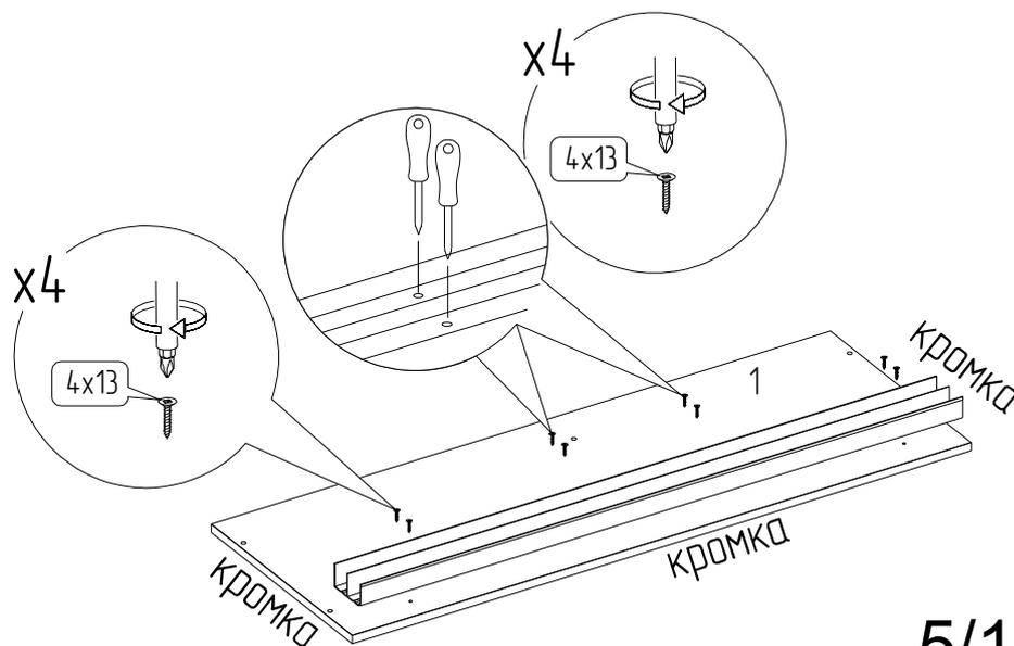
**6** Установка стенок горизонтальных.
