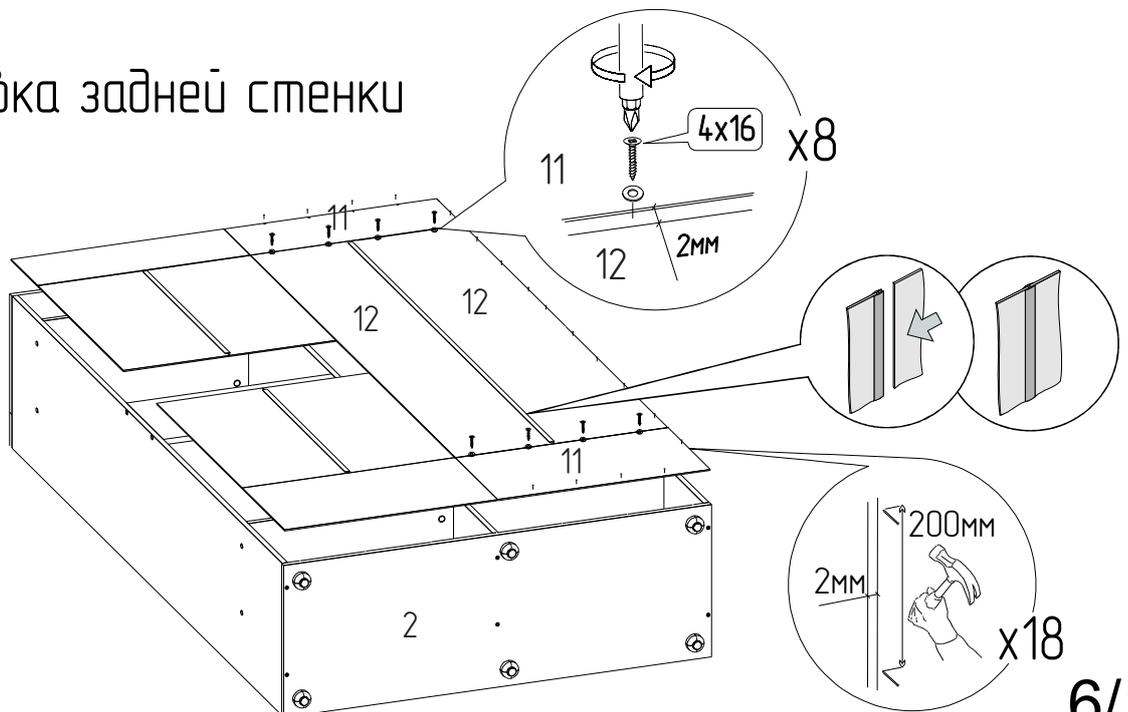
**9** Установка задней стенки
