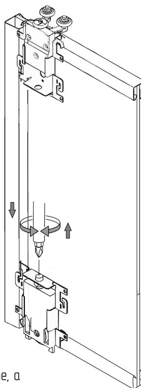
Завести верхние ролики двери в верхнюю направляющую шкафа купе, а нижние ролики в пазы нижней направляющей. Выверить по отвесу вертикальность двери, перемещая ее вместе с нижней направляющей.
