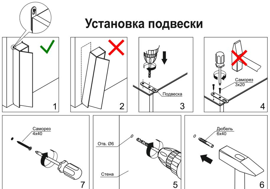
Во избежание опрокидывания изделия во время эксплуатации закрепить его к стене (см. схемы 1, 2). Для разных материалов стен требуются различные крепления, используйте крепёжные средства, подходящие для материала стен в вашем доме. На схемах 3 - 8 показана последовательность крепления изделия к стене с использованием дюбелей.
