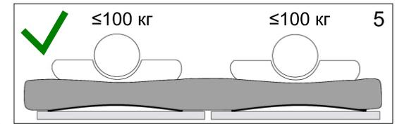
Распределяйте нагрузки равномерно по всем рабочим поверхностям (см. схему 1). Самые тяжелые объекты рекомендуем ставить по краям (см. схему 2). Сосредоточенная в одном месте нагрузка (см. схемы 3, 4) нарушает устойчивость изделия, а также сокращает срок службы отдельных элементов и механизмов.
